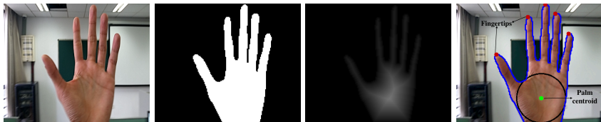
(a) Input frame (b) Binary image (c) Distance transform (d) Fingertips image
